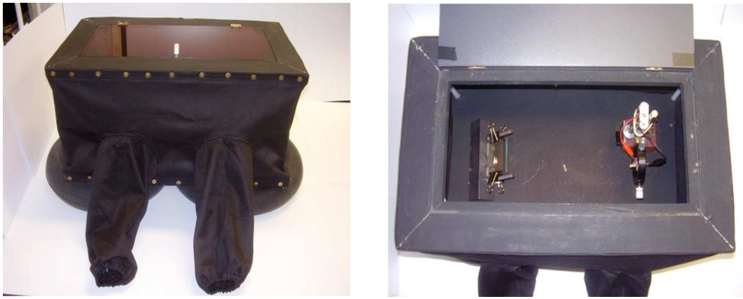
Figura 3 - Dos vistas de la instalación experimental portátil para la obtención de hologramas.
