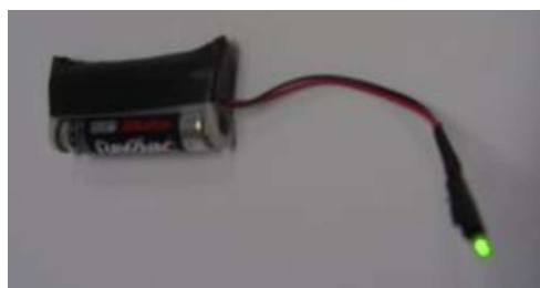
Figura 8 - LED verde acoplado a baterías.
