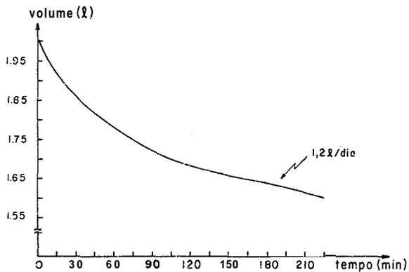
Fig.2 - Volume de hélio restante em função do tempo após o final da transferência do mesmo para o interior do Dewar.
