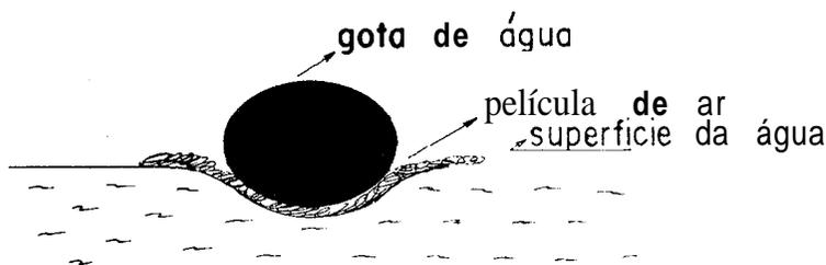
**Fig. 3** – A espessura da película de ar (mostrada em dimensões exageradas) determina o tempo de vida da gota e o valor da força de atrito.
